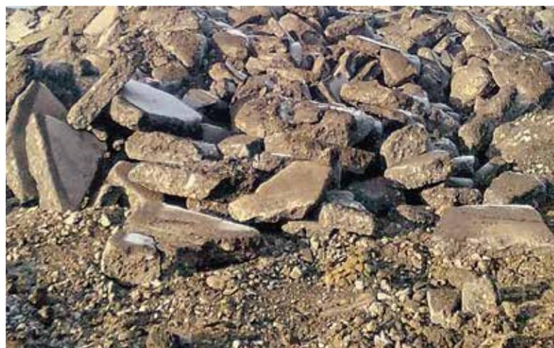
Abb. 7: „Haufwerk A“ – Asphalt der Platzbefestigung (Foto: DEUTAG Ost)
